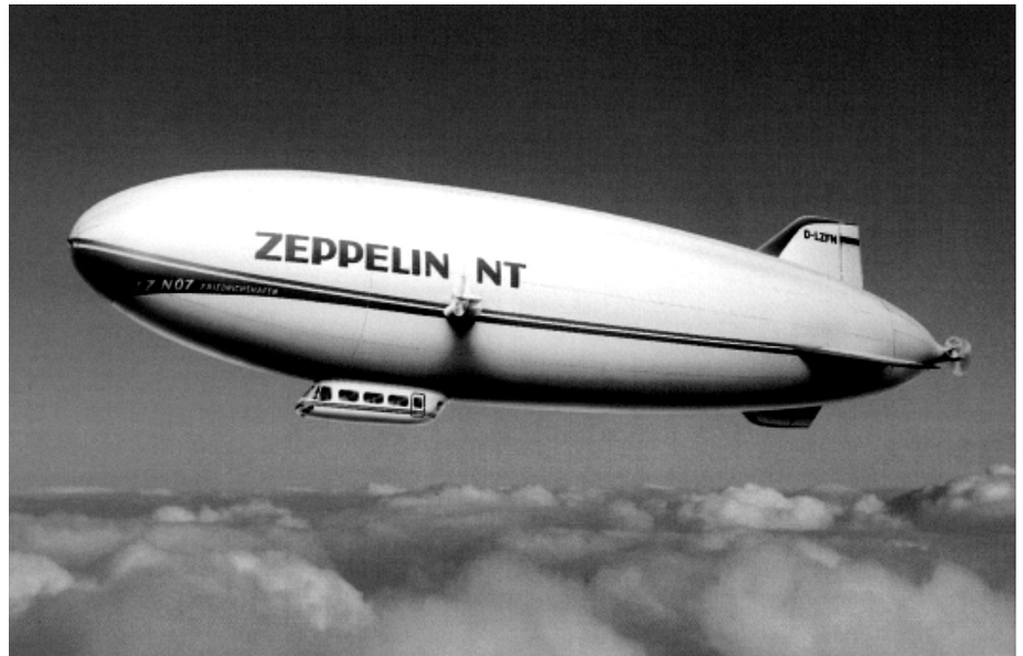
Abb. 3: Der erste Zeppelin „neuer Technologie“ wird gegenwärtig in Friedrichshafen gebaut. Der Prototyp LZ N07 ist 68 m lang und kann zwei Piloten und zwölf Passagiere mit 115 km/h (max. 140 km/h) befördern. Sein Jungfernflug wird 1997 stattfinden. Danach beginnt die Serienfertigung auch größerer Zeppelin NT-Luftschiffe für Tourismus, Forschung und Umweltschutz mit einer Kapazität bis zu 84 Sitzplätzen.
