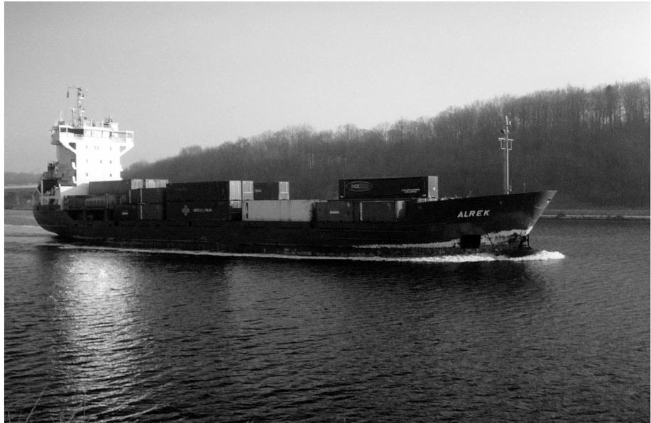
Foto 2: Der Container-Feeder M/S „Alrek“ (Ladekapazität 150 TEU, Geschwindigkeit 15 kn, Tiefgang 6 m) kehrt von einer seiner zahlreichen Ostseefahrten in den Nordostseekanal (Bild) zurück; an seiner Bugspitze Schäden, die vom winterlichen Ostseeverkehr herrühren.
