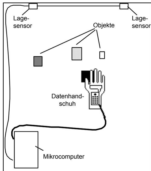
Abb. 2.1: Prototyp - Werkstatt-Layouterstellung mit Modellen (Draufsicht)
