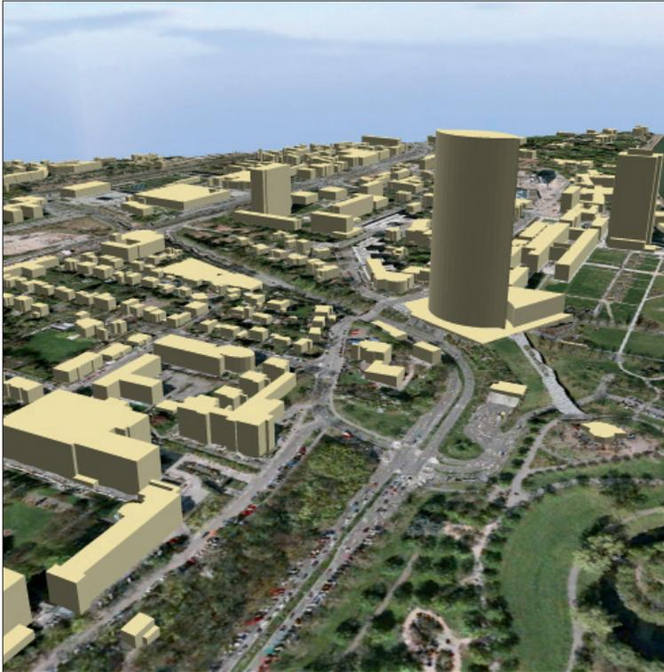
Abb. 3: Darstellung des 3D-Gebäudemodells im Level of Detail 1 (LoD1) mit Digitalem Geländemodell und Digitalem Orthophoto (Quelle: Bezirksregierung Köln, Abteilung Geobasis NRW)
