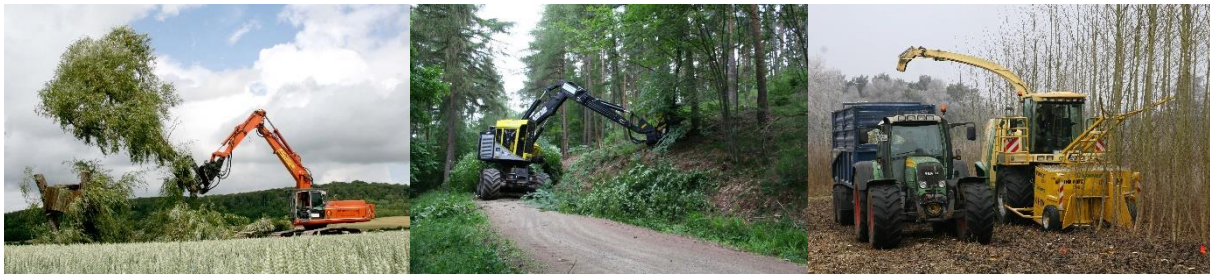
Abb. 41: Beispiele für Erntetechnik der Firma Hüttmann für die Bereiche Landschaftspflege, Waldrestholz und Kurzumtriebsplantagen (v.l.)
