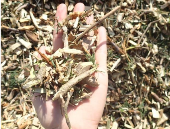
Abb. 37: HHS aus Landschaftspflegeholz unterschiedlicher Größe und Beimengungen
