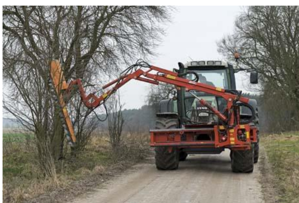
Abb. 29: Traktor mit einer Ast- und Heckenschere mit einer Arbeitsbreite von 2,20 m, Arbeitshöhe und Arbeitsweite von 6 m, max. Astdurchmesser ca. 15 cm
