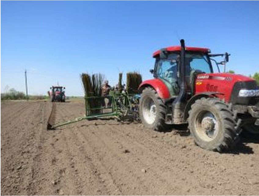
Abb. 27: Rutenpflanzmaschinen vom Typ Step-Planter auf ordnungsgemäßem Saatbeet Foto: Neumeister
