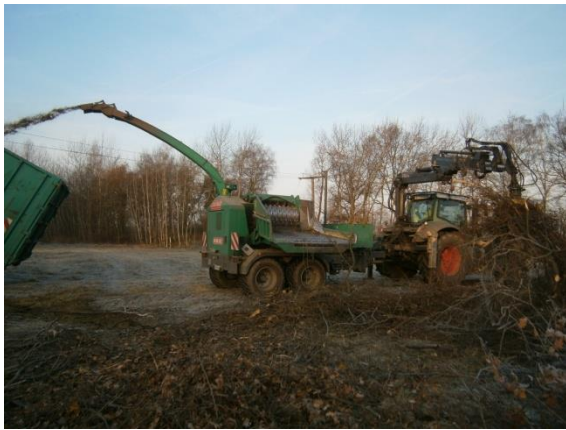
Abb. 32: Mobilhacker beim direkten Aufblasen der HHS
