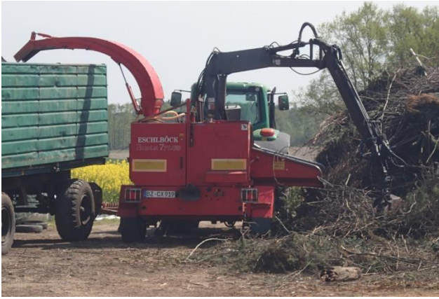
Abb. 33: Kranbeschickter Hacker, der in einer Gemeinde von Bürgern angeliefertes Astmaterial zu HHS verarbeitet
