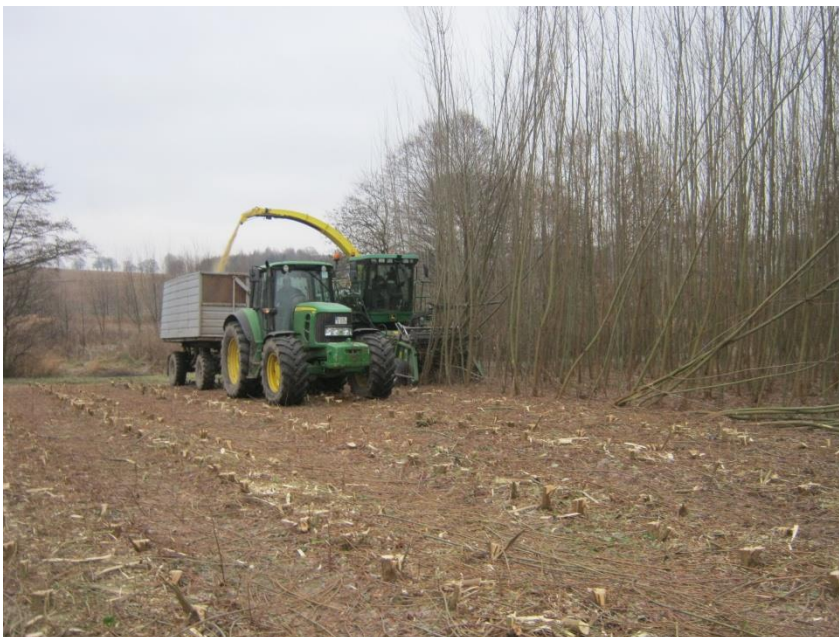
Abb. 28: Feldhäcksler 7400 von John Deere mit Erntevorsatz HSAB der Firma SalixEnergi im KUP Ernteeinsatz Foto: Neumeister
