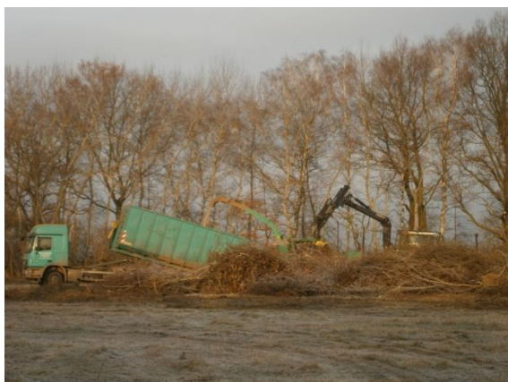
Abb. 31: Hacken eines großen Haufwerkes Äste, die beim Freischneiden von Feldrändern und –wegen angefallen sind
