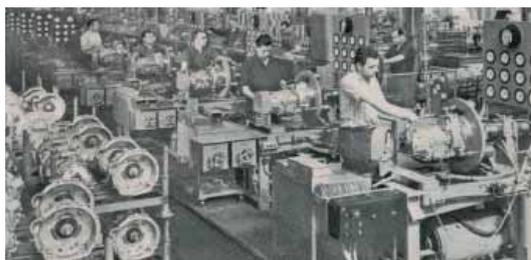
Automatikgetriebe-Produktion Mitte der 1960er-Jahre
