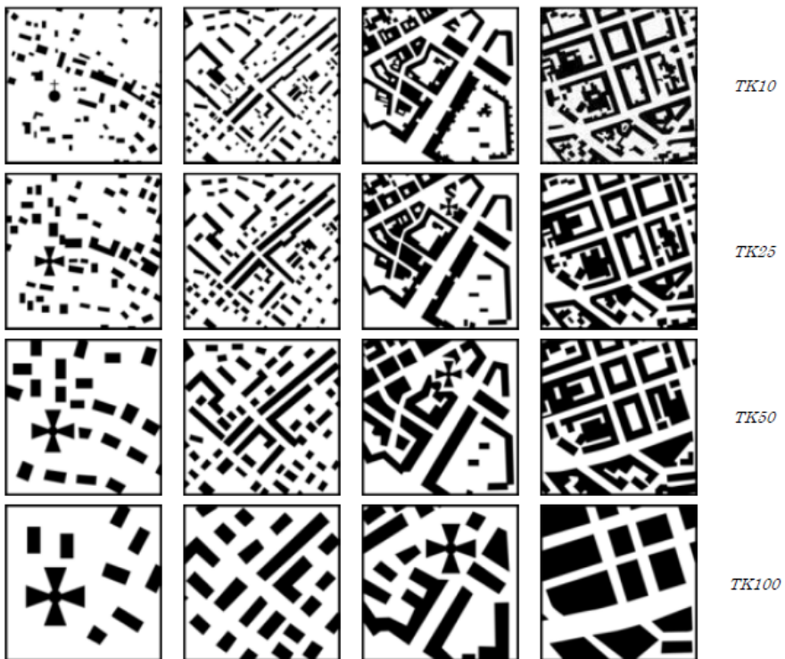
Abb. 6-2: Gebäudedarstellung in den topographischen Karten unterschiedlichen Maßstabs (TK10, TK25, TK50, TK100) für verschiedene Regionen: a) ländlich: Carlsfeld; b) vorstädtisch: Aue; c) städtisch: Dresden; d) innerstädtisch: Leipzig (Quelle: Körner, 2011)
