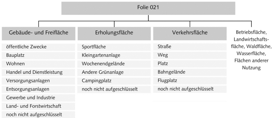
Abb. A-1: Modellierte Objektarten der Nutzung aus Folie 021 mit Fokus auf die bebauten Flächen aus der Verwaltungsvorschrift des Freistaates Sachsen (VwVLika 2005)
