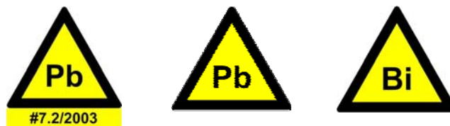
Abbildung 3: Beispiele für die Kennzeichnung von Schadstoffen in elektronischen Bauteilen 19
