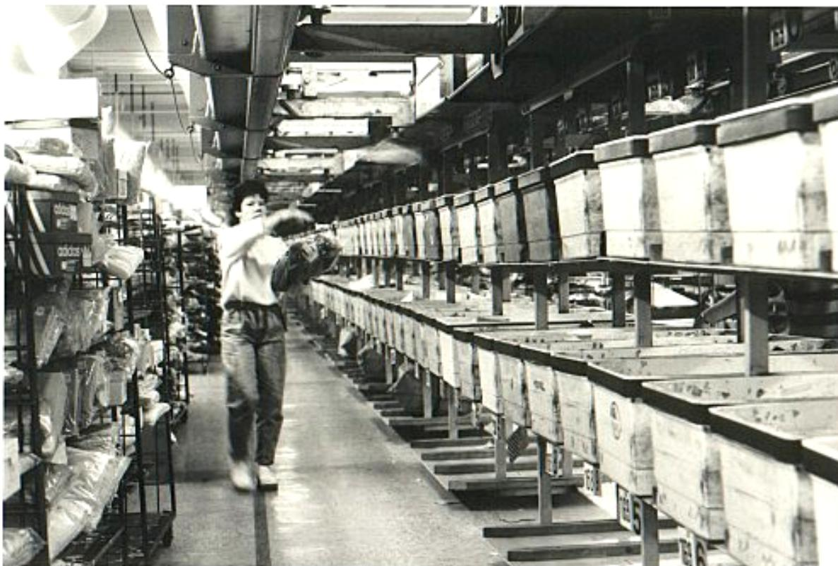
Abb. 2: Eine Werferin geht ‚am Band‘ (am Hängeförderer) entlang und wirft Ware in die zutreffende Wanne. Gut sichtbar ist die Bogenkonstruktion, an der die gesamte Anlage aufgehängt ist (Foto: Otto).
