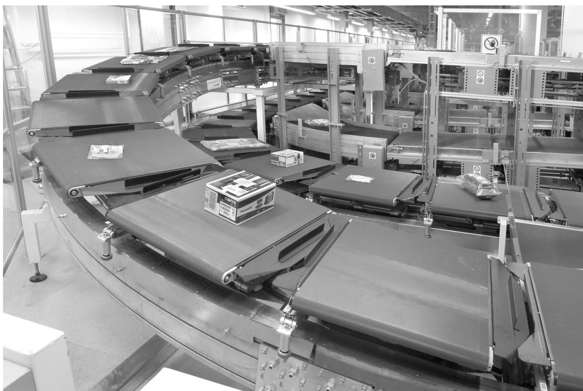
Abb. 3: Artikel auf den Sorter-Zellen. Die Ware läuft so lange auf dem Sorter-Kreisel, bis der vorgesehene Packplatz frei ist, wo sie abgeworfen werden kann. Zuvor wird die Ware per Barcode identifiziert, sodass jede Zelle ‚weiß‘, welcher Artikel sich auf ihr befindet und in welchen Packplatz er gelenkt werden soll. Die Zusammenführung der verschiedenen Artikel derselben Warensendung geschieht nicht mehr durch das ‚Werfen‘, sondern durch die Fördertechnik (Foto: Otto).
