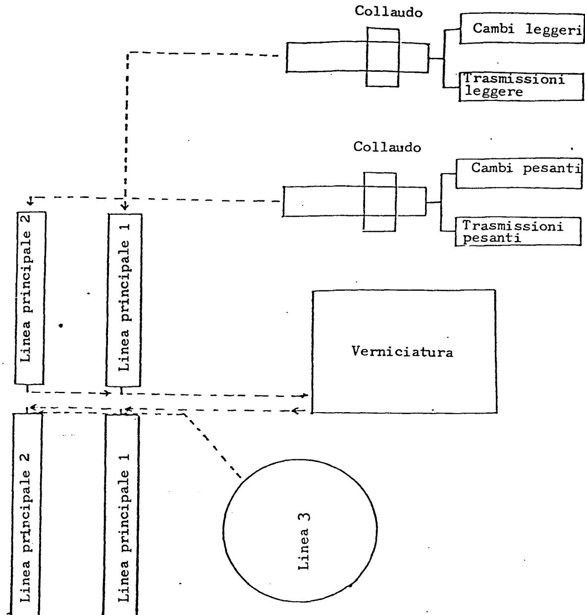
Per quanto attiene al personale impiegato, al primo tratto delle due linee di montaggio si avevano 9 postazioni fisse nel montaggio cambi leggeri e 9 nel montaggio delle relative trasmissioni (altrettante per cambi e trasmissioni pesanti). Attorno alle postazioni fisse c'erano gruppi di preparazione materiali (ciascuno composto di 6 persone), più un "operaio-jolly" ogni 9 operai (per consentire le pause fisiologiche) ed un "fuorilinea" che interveniva sulle anomalie e sulle varianti.
