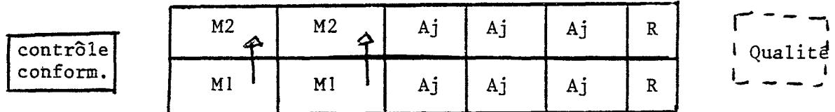
Le module lui-même est donc constitué d'une douzaine de postes ; 4 postes de montage, 6 postes d'ajustage, 2 postes de réparations. On trouve en amont du module un contrôle de conformité, et en aval un poste de contrôle qualité.
