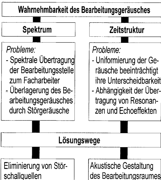
Bild 3.21: Probleme und Lösungsansätze zur Wahrnehmbarkeit des Bearbeitungsgeräusches
