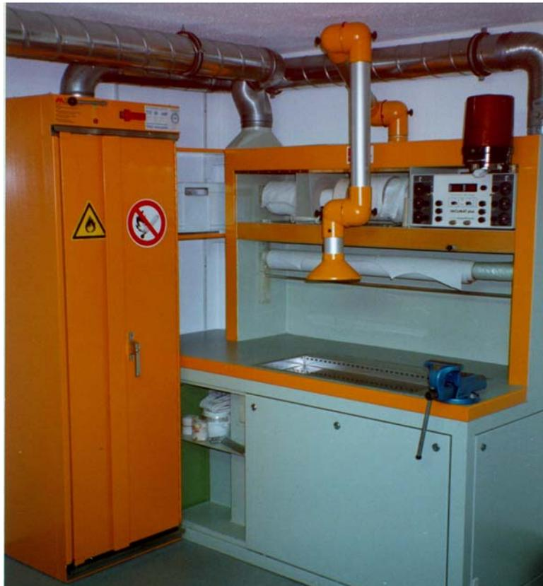
Abbildung 3-17: Gefahrstoffschränk und beispielhafter Arbeitsplatz mit Absaugung der Stäube und Klebstoffdämpfe
