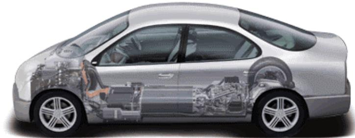
Bild 61: Das Honda Konzeptfahrzeug FCX mit „Twin Solid Concept“ (Quelle: Honda)
