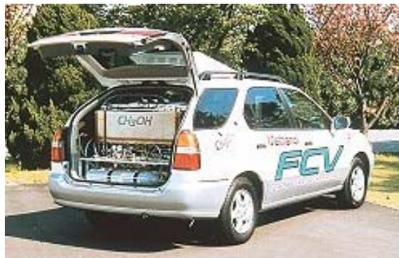
Bild 74: Nissan R'nessa FCV mit Brennstoffzellensystem im Kofferraum (Quelle: Nissan)
