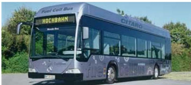
Bild 18: Citaro Brennstoffzellenbus von DaimlerChrysler in Hamburg (Quelle: Hamburger Hochbahn)
