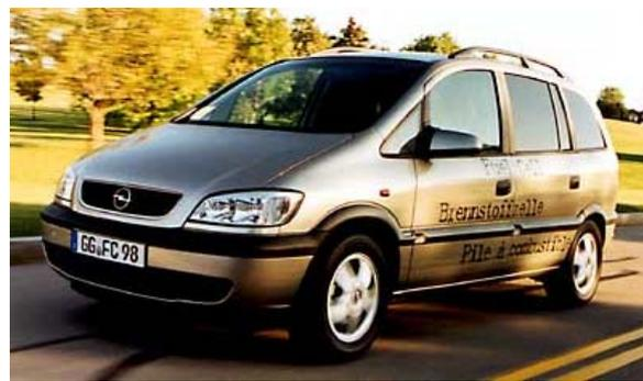
Bild 43: Zafira Brennstoffzellenfahrzeug (Quelle: www.h2cars.de)
