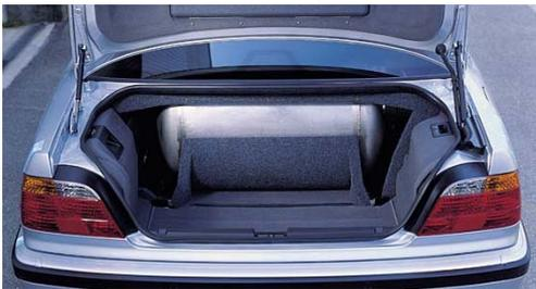
Bild 4: Kryogener Wasserstofftank hinter Rückbank (Quelle: BMW)
