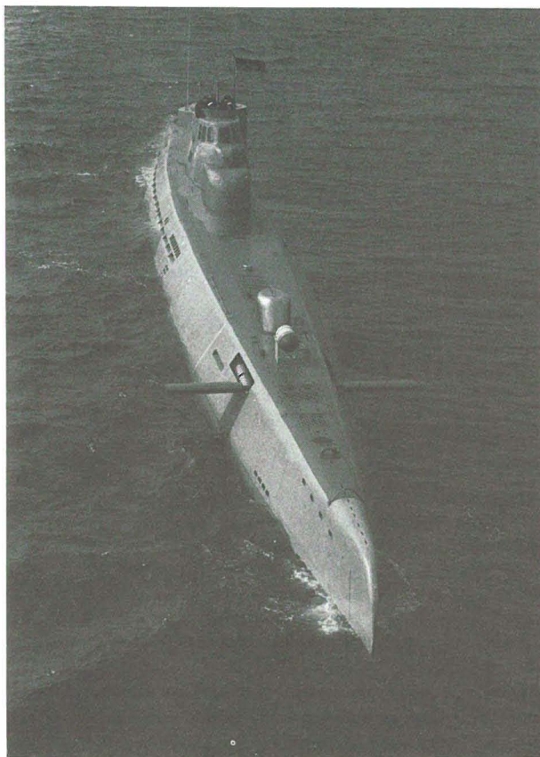
U WILHELM BAUER etwa 1973 mit ausgeklappten vorderen Tiefenrudern. Auf dem Vorschiff sind der KUBA Sonardom und ein weiteres Gerät zu erkennen. (Foto Marineamt)
