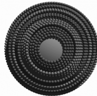
Abbildung 3: Illustration zum angenommenen „Schrottwolken-Szenario“ in den Modellrechnungen. Durch eine Rakete wird eine Nutzlast in die Bahn eines Satelliten gebracht und dort eine Trümmerschwemme erzeugt, um den Satelliten durch Kollision zu zerstören (Skizze links). Die rechte Skizze illustriert den modellierten Aufbau (Teil) der Nutzlast, ein von kleinen Kugeln umgebener Kern aus Sprengstoff.
