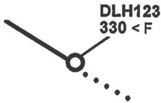
Jedes der Flugzeuge wird als eine Nadel abgebildet, die die Richtung des Flugzeugs anzeigt. Aus der Länge der Nadel ist abzulesen, wo sich das Flugzeug in einer Minute befindet. Über die Buchstaben- und Zahlenkombination "DLH123" erreicht der Lotse per Funk den Piloten des Flugs. "330" gibt die aktuelle Flughöhe an, das Kürzel "<F" gibt darüber Auskunft, dass das Flugzeug in Frankfurt gestartet ist.
